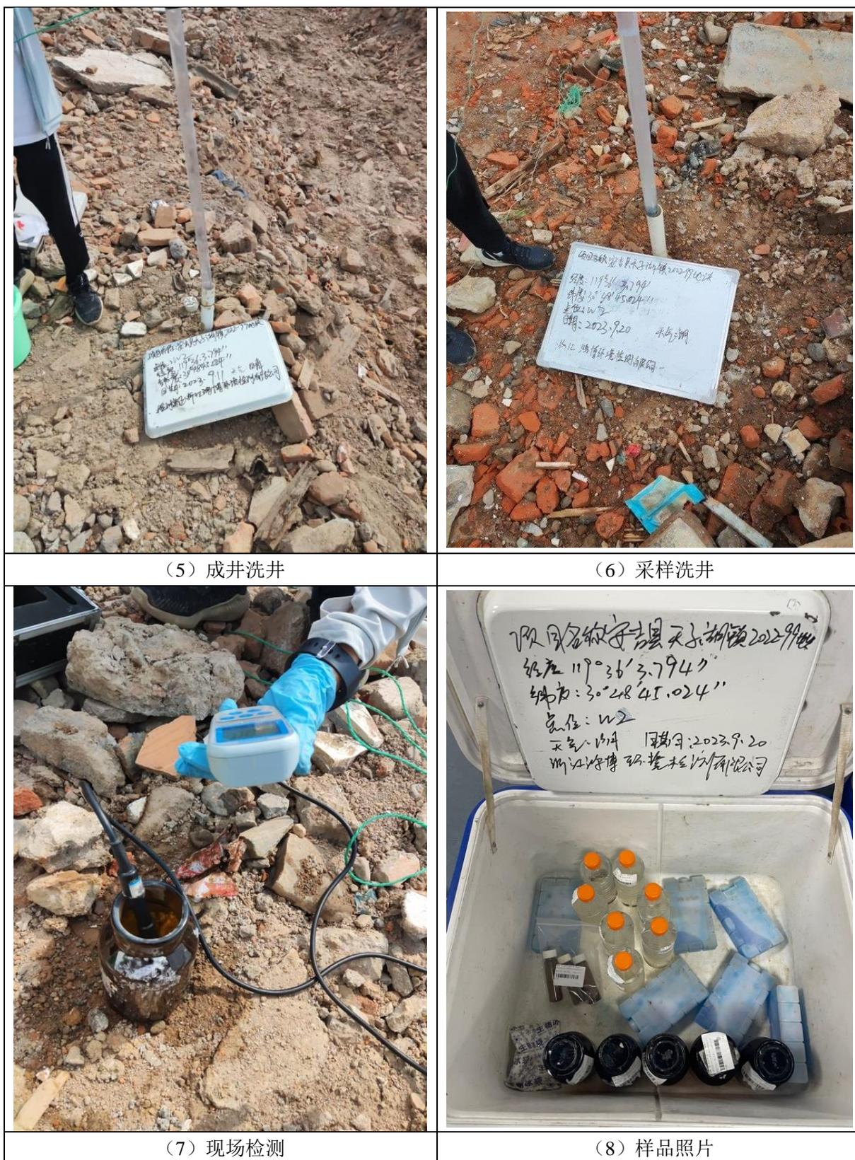
图5-5 部分地下水建井、洗井、检测照片
