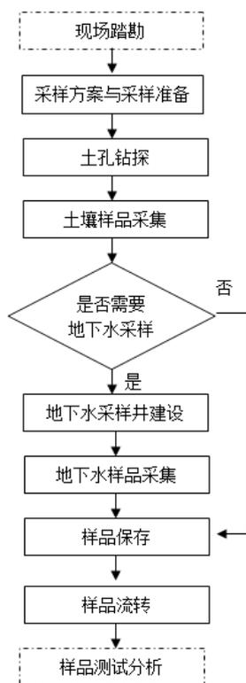
图6-4 样品采集、保存、流转工作程序图
