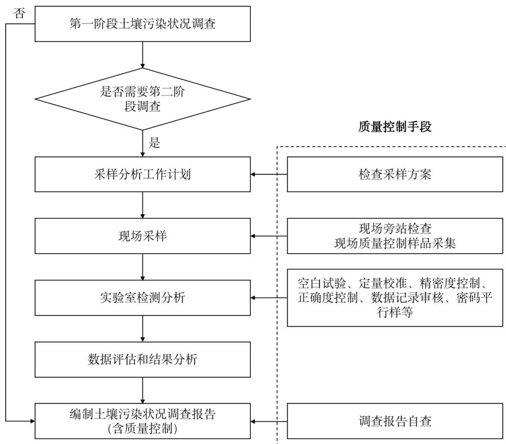
图6-1 本次调查质量控制工作流程图
