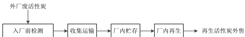
图 4.2-2 本项目废活性炭再生总体工艺流程图
