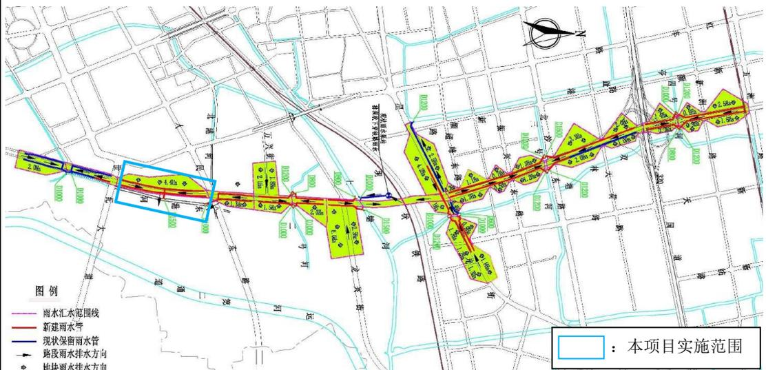
图 2-7 乔司至东湖连接线二期工程雨水总体图
